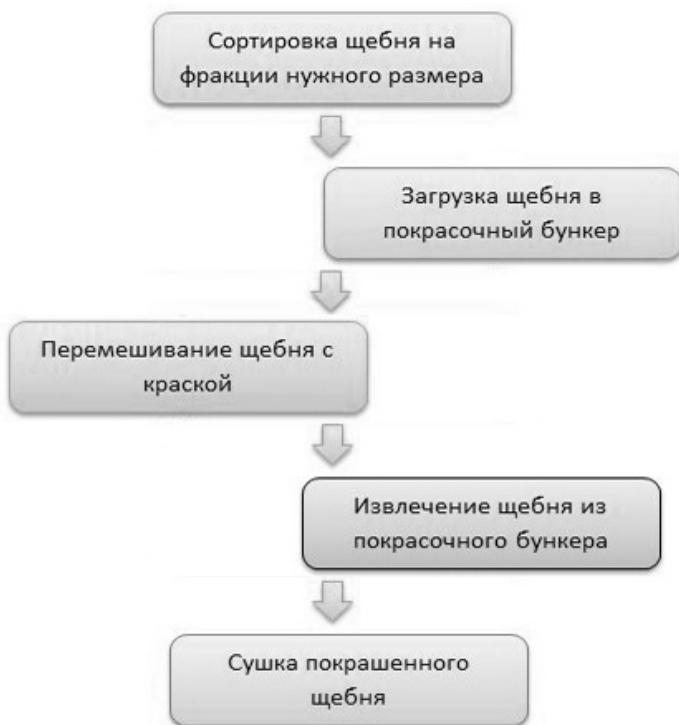
Рис. 1. Особенности технологии производства цветного щебня
